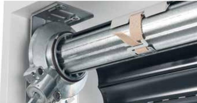
**Axe** avec supports en acier zingué conformes à l'installation immédiate dans la plupart des embouts existants. L'enroulement du tablier est possible aussi bien vers l'extérieur que vers l'intérieur.
