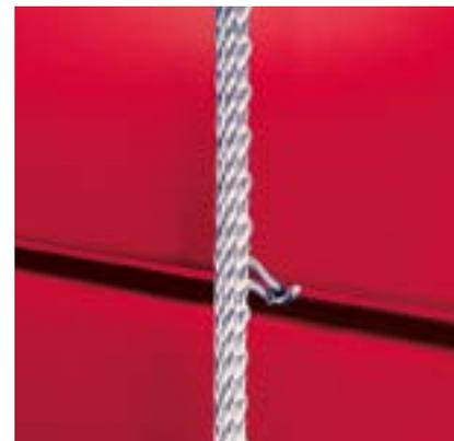
**Liaison optimale:** la liaison brevetée entre les lamelles et la bande-échelle, se fait à l'aide d'un œillet en acier inoxydable serti dans le retour de la lamelle sans pour autant l'affaiblir.
