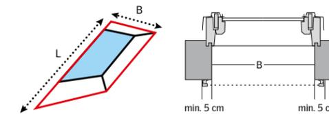
Mesurez la découpe du toit comme indiqué à l'image pour déterminer la dimension correcte de la moustiquaire. Il faut au moins 5 cm de surface plane tout autour de la découpe du toit.
