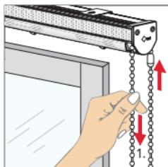
1. Bedienkette bis zum Anschlag des Ketten-schlusses hochziehen
